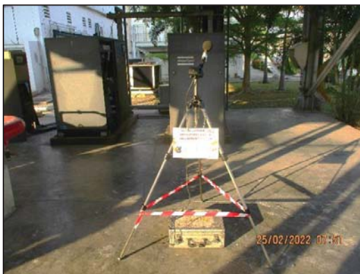
รูปที่ 3-11 การตรวจวัดระดับเสียงในพื้นที่ทำงาน บริเวณ Air Compressor
