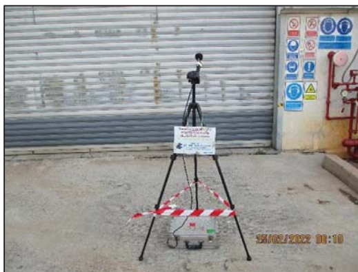
รูปที่ 3-12 การตรวจวัดระดับเสียงในพื้นที่ทำงาน บริเวณ Steam Turbine Generator
