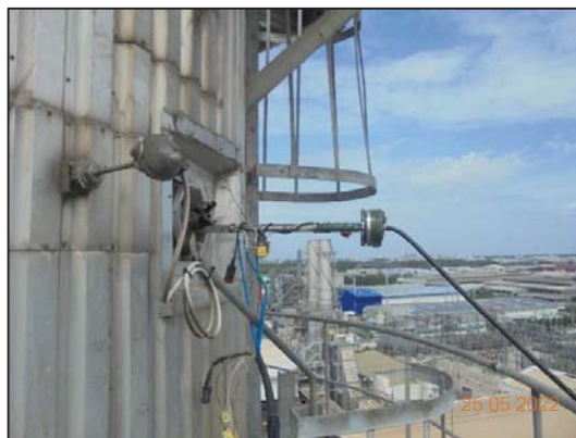
รูปที่ 3-1 การเก็บตัวอย่างคุณภาพอากาศในปล่องระบาย บริเวณ Stack HRSG11
