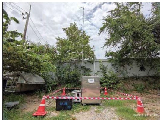
รูปที่ 3-3 การเก็บตัวอย่างคุณภาพอากาศในบรรยากาศ บริเวณ บ้านก้นทุ่ง ตำบลหนองไผ่แดง
